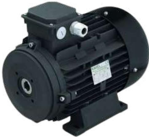
Motor assíncrono eléctrico trifásico de alta qualidade com rotor tipo gaiola, totalmente fechado e refrigerado por ventilador de ventoinha, está disponível em diversas tensões e frequências, também com customizações para atender cada necessidade. Com flange e veio interno para maior eficácia e poupança de peso e tamanho no acoplamento à bomba de alta pressão.
